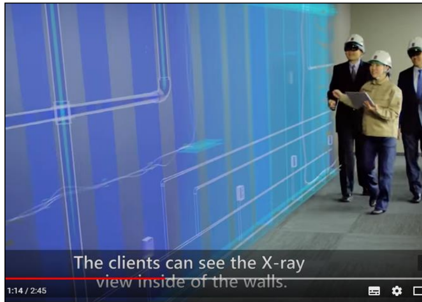
MRによって壁内部の配水、配電を紹介する様子
