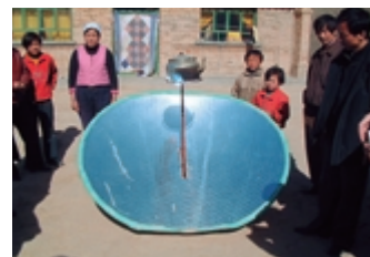
太陽熱で湯沸し (黄土高原、中国)
