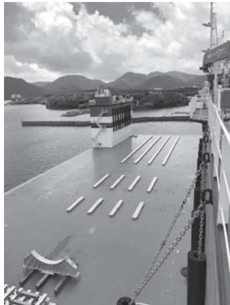
図表 27：フロートレイザーの積み込み部
